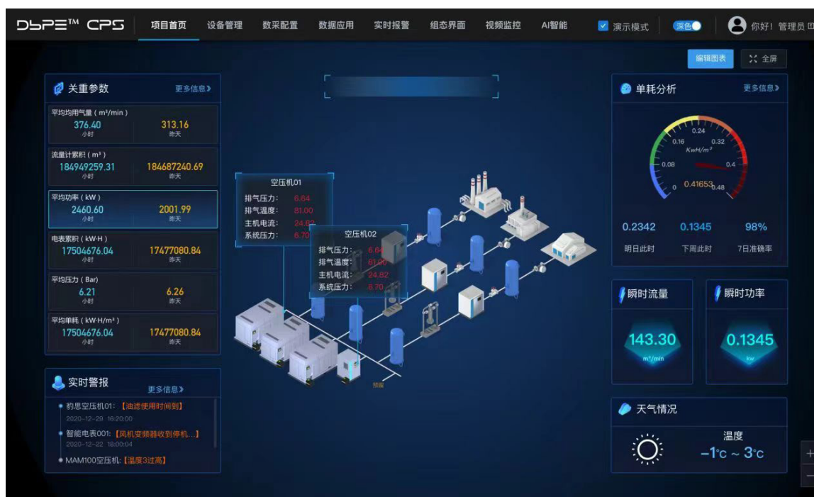
图：园区双碳能源管理平台可视化界面
